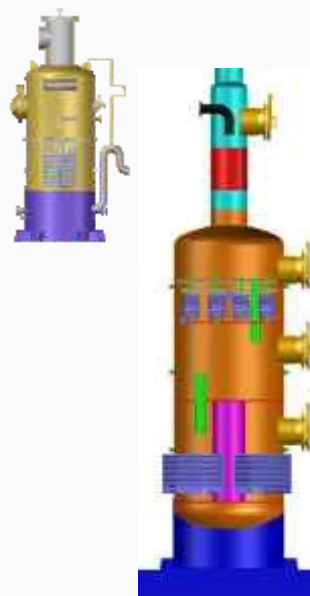
نمای داخلی بی بوکن مداوم برای روغن با اسید چرب آزاد بالا
